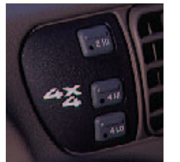
Heckantrieb, starrer Allradantrieb und Reduktion: beim Chevrolet Blazer alles auf Knopfdruck
