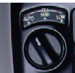
Im Ford Explorer schaltet sich die Vorderachse automatisch stufenlos zu, auch starrer Durchtrieb ist wählbar
